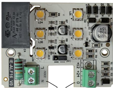
**COLLEGAMENTO PER 12Vdc, 24Vdc e 230Vac**
