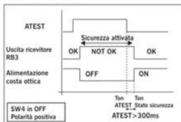
Nel caso in cui si lavori con coste ottiche, in modalità ON è permesso utilizzare solo coste sempre attive OSE-S7502B e OSE-S7502. La comunicazione radio viene verificata ogni 7 secondi.
