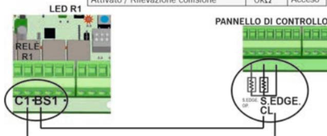
L'apparecchio può essere connesso al quadro di manovra con ingresso per costa di sicurezza 8k2 o direttamente in un ingresso di sicurezza di contatto normalmente chiuso come se si trattasse di una fotocellula o di un segnale di STOP.
