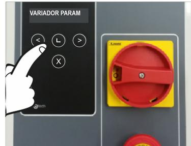
Para inicialiar los parámetros del variador, pulsar las teclas o durante 2s para entra en PROGRAMACIÓN, seleccionar el menú CONFIG PARÁMETRO con la tecla o y validar con la tecla ENTER .
