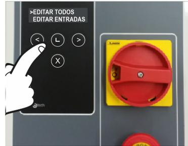
Para inicializar los parámetros del variador, pulse la tecla **<** o **>** durante 2 segundos para pasar a PROGRAMACIÓN, seleccione el menú CONFIG PARÁMETRO con la tecla **<** o **>** y valide con la tecla ENTER **L**.
