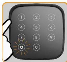
Dopo un corretto reset, le password di default vengono ripristinate, per sicurezza, la tastiera e' resettata dal ricevitore (deve essere riprogrammata)
