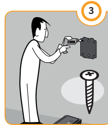
LÖCHER IN DIE WAND BOHREN UND HALTERUNG ANSCHRAUBEN
