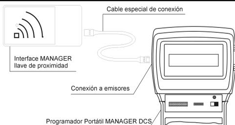
Introduzca un extremo del cable de conexión especial en la ranura de la Interface MANAGER de llave de proximidad y el otro en la conexión de emisores del Programador Portátil MANAGER+DCS (ver figura pág. 6, núm. 8 del manual del MANAGER+DCS).
