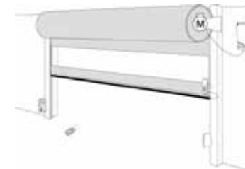
Esempio di installazione in porta rapida con quadro di manovre e RadioBandRU o RadioBandUMS
