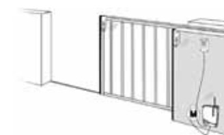
Esempio di installazione in porta scorrevole con quadro di manovre e RadioBandRU o RadioBandUMS
