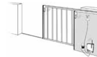
Exemple installation sur une porte coulissante d'une feuille avec armoire de commande et RadioBandRU ou RadioBandUMS
