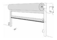
Ejemplo instalación en puerta rápida con cuadro de maniobras y **RBMOT**30/500 o **RadioBand**RU o **RadioBand**UMS
