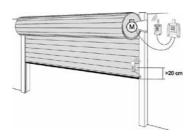
Ejemplo instalación en puerta enrollable con cuadro de maniobras y **RBMOT**30/500 o **RadioBand**RU o **RadioBand**UMS
