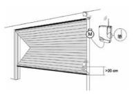
Ejemplo instalación en puerta basculante de dos hojas con cuadro de maniobras con conector para targeta **RadioBand**RCS o **RadioBand**CSM
