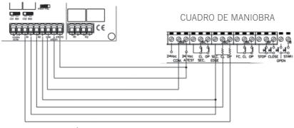
CONEXIÓN DE DOS BANDAS DE SEGURIDAD CON AUTOTEST NEGATIVO.
