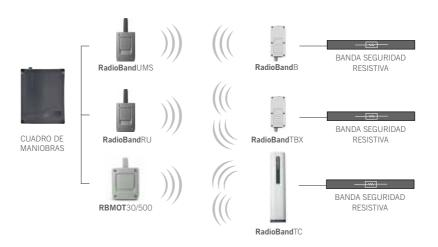
sistemas de comunicación vía radio para bandas de seguridad
