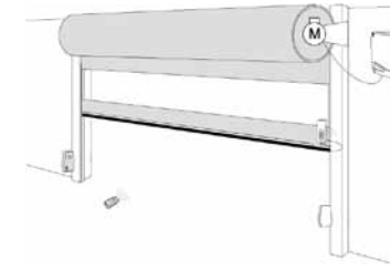
Beispiel an einem Schnellaufator mit einer Motorsteuerung und dem RadioBandRU oder RadioBandUMS
