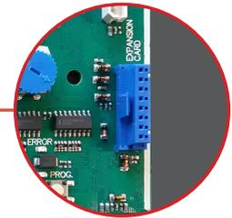
Con conector para tarjetas de expansión en placa.
