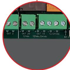
Salida de 12Vdc para electrocerradura de hasta 3A.
