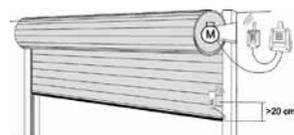
Exemple d'installation sur porte enroulable avec armoire de commande et **RADIOBANDRU**
